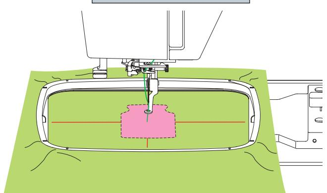
Наложите аппликацию на основную ткань и обведите контур аппликации с помощью маркера. Зафиксируйте аппликацию на основной ткани с помощью клеевого спрея или булавок.
