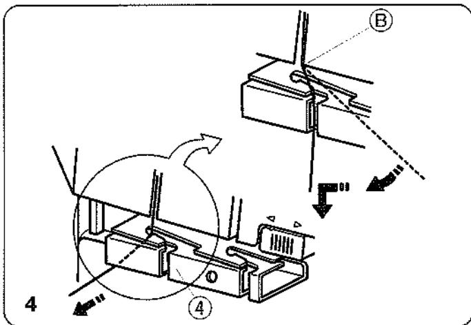
4. Набросьте нить на угол В, затем пропустите ее сквозь нитенаправитель петлителя.
