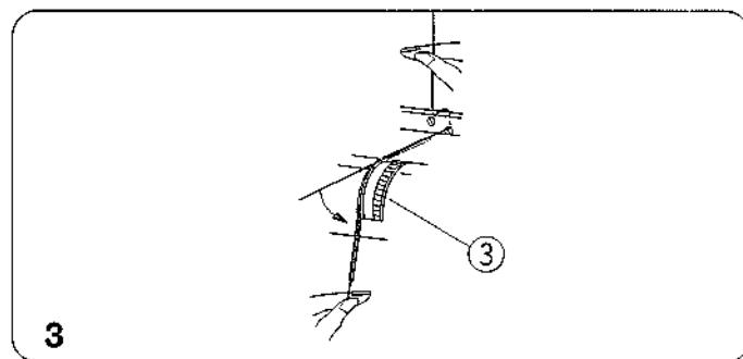
3. Удерживая нить с двух сторон, слегка ее потяните, и проверьте, правильно ли она расположена между дисками натяжения. (Если рычаг прижимной лапки поднят, нить легко попадет между дисками натяжения.)
