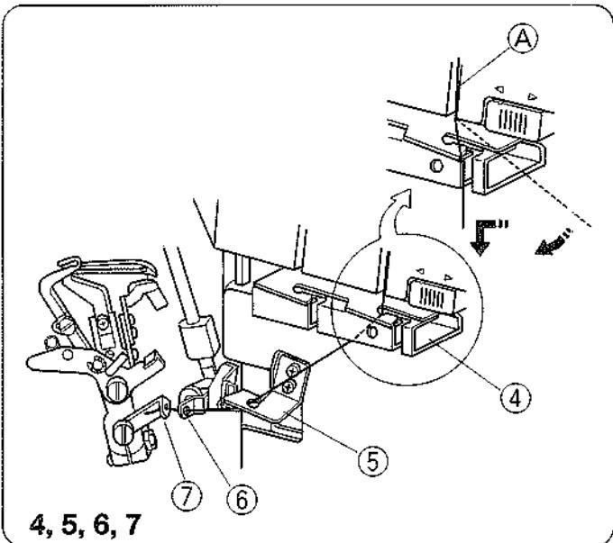
4. Набросьте нить на угол А, затем пропустите ее сквозь направитель нижнего петлителя.
