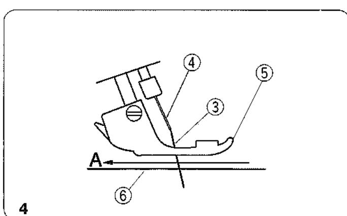
4. При помощи линзета вытяните нити из-под прижимной лапки и отведите игольные нити назад над игольной пластиной. Вытяните их на 10 см от прижимной лапки. (Отводите игольную нить в направлении А).
