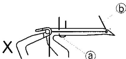
10. Поверните маховое колесо и передвиньте нижний петлитель в крайнее правое положение. При помощи пинцета вытяните нить на 10 см или более сквозь отверстие нижнего петлителя.
