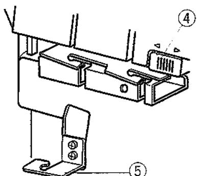
Для стандартного оверлокивания в две нити, установите механизмы машины как показано на рисунке.
