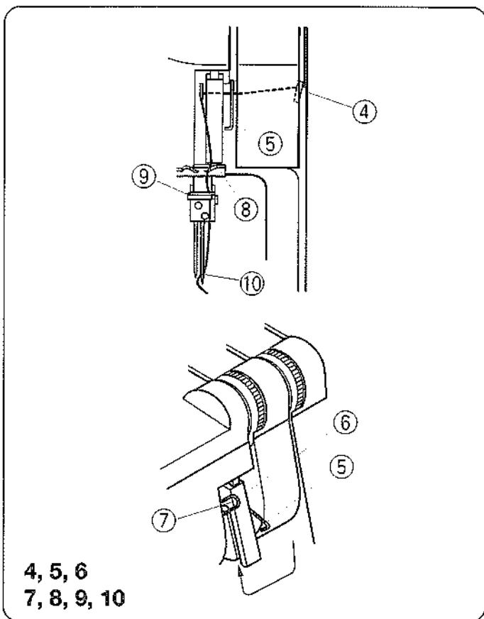
4, 5, 6. Пропустив нить сквозь нитенаправитель (1) на передней панели, направляйте ее через низ нитенаправителя (2) на передней панели и панели рычага нитеводителя справа налево.
