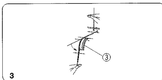
3. Удерживая нить с двух сторон, слепка ее потяните, и проверьте, правильно ли она расположена между дисками натяжения. (Если рычаг прижимной лапки поднят, нить легко попадет между дисками натяжения.)
