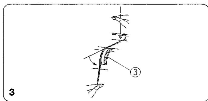
3. Удерживая нить с двух сторон, слегка ее потяните, и проверьте, правильно ли она расположена между дисками натяжения. (Если рычаг прижимной лапки поднят, нить легко попадет между дисками натяжения.)
