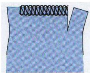
Если оверлочивать и обрезать одновременно, следует вручную разрезать ткань в каждом углу вдоль линии стежков на 3 см перед поворотом ткани. Сделайте надрезы на ткани перед началом строчки.
