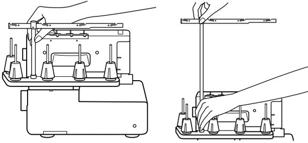
1. Вставьте антенну в отверстие в основе под катушки, расположенной сзади машины. Проверьте, чтобы антенна правильно и прочно вошла в отверстие.
