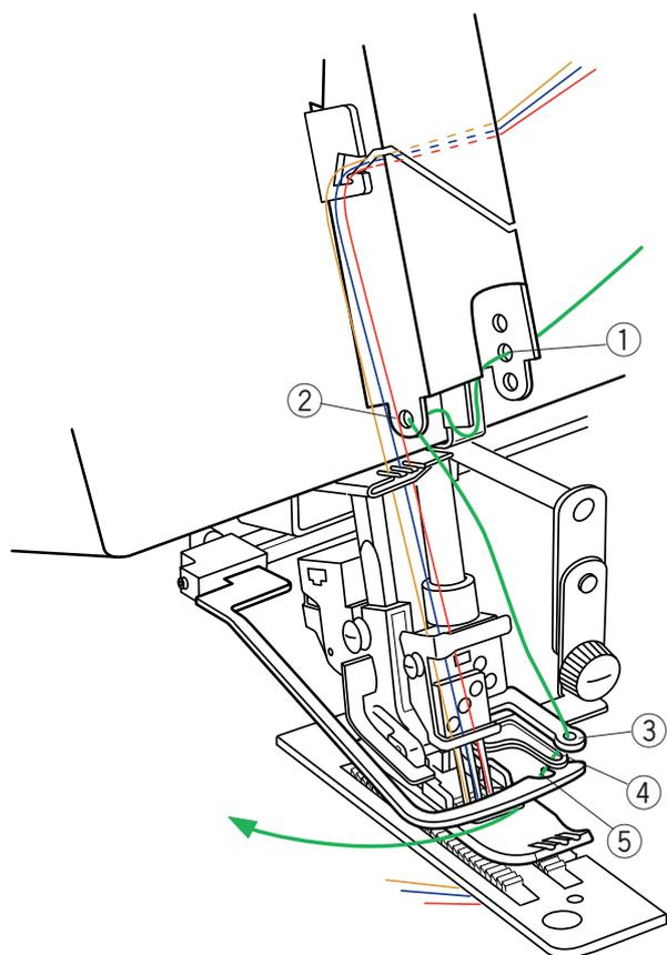
11. Закрыть переднюю крышку. Рукой повернуть на себя маховое колесо и проверить движения устройства распределения, поднять иглы.
