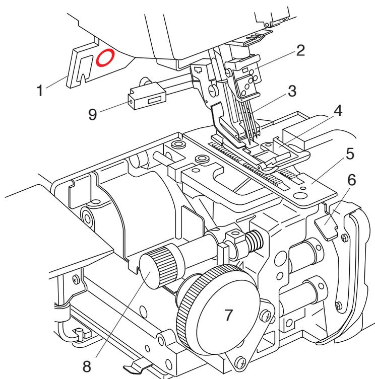
1. Рычаг прижимной лапки и нитеобрезатель
