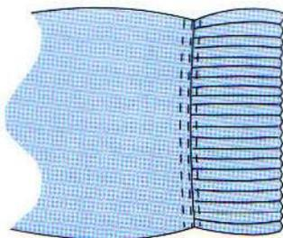
Пришейте резинку к ткани при помощи 3-ниточного Широкого стежка или 4-ниточного Закрепочного стежка. Настройте машину на Тройной распошивальный шов. Шов можно расположить либо ближе к резинке, либо к ткани изделия. Прострочите, позволяя центральной игле “соскакивать”. Внешние иглы будут прострачивать ткань и резинку одновременно.
