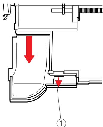
Чтобы установить швейный столик, надо расположить его на внешней стороне передней крышки. Пристегнуть столик на защёлки на место.
