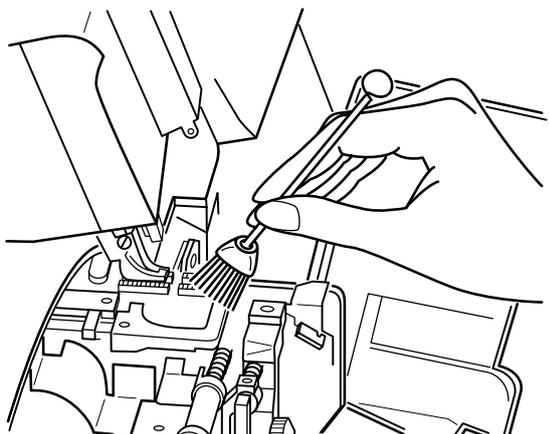
Снова установите игольную пластину, нажав вниз на её переднюю часть и пристегнув её к винту игольной пластины (b).
