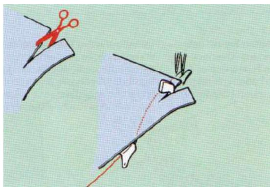
Положите ткань прямо перед иглами. Возможно, потребуется вручную отрезать первые 3 см вдоль линии шва. Опустите прижимную лапку и прошейте. Оверлочная цепочка автоматически ляжет в шов на изнаночной стороне ткани.
