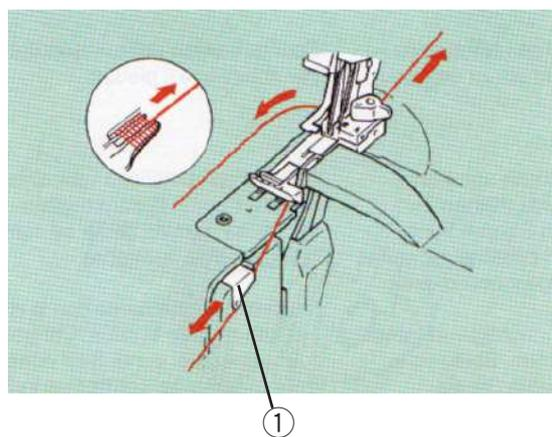
Поднимите прижимную лапку и осторожно снимите оверлочную цепочку с постоянного устройства роликового шва (штифт ширины стежка). Отведите стежки назад, а затем вокруг и вперед. Зафиксируйте нитки в устройстве закрепки.
