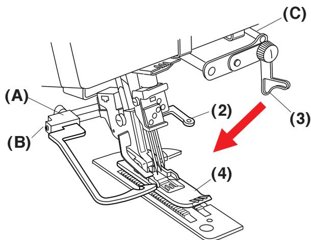
10. Повернуть на себя маховое колесо и проверить движение устройства распределения.
