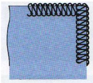
Остановите оверлок как только достигнете края ткани, поднимите иглу в самое верхнее положение. Поднимите прижимную лапку. Нажмите на рычаг снятия натяжения, одновременно аккуратно снимите стежки с пальца стежков. Поверните ткань. Совместите прошитые стежки с иглой. Опустите прижимную лапку и подтяните вверх игольную нить, чтобы убрать провисание. Начинайте шить.
